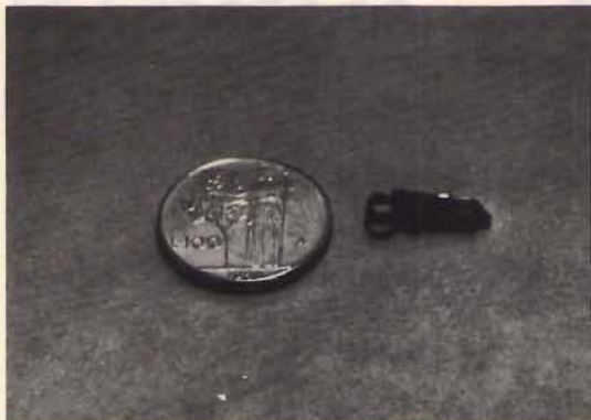
Foto di un prototipo (sola parte oscillatrice AF); la moneta da 100 lire da un'idea delle dimensioni. Purtroppo la foto non è molto chiara, a causa dell'estrema miniaturizzazione del circuito.
